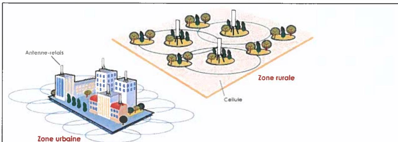
**L'antenne-relais émet des ondes dans une direction privilégiée. Ce faisceau peut être comparé à celui d'un phare qui éclaire la mer. Les faisceaux principaux de l'antenne sont directifs et très fins (6 degrés environ) dans le plan vertical. L'intensité du faisceau diminue très rapidement (en fonction du carré de la distance) en s'éloignant de l'émetteur. Cf. schéma ci-dessous à titre indicatif.**
